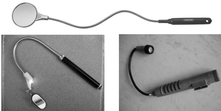
Fot. 21. Sprzęt pomocny przy podglądzie dziupli: lusterko na giętym wysięgniku, lusterko wraz z zamontowanym światłem diodowym używane w mechanice samochodowej oraz latarka z giętką końcówką (fot. R. Mikusek).
