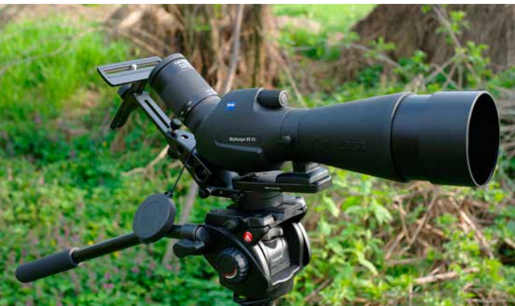
Fot. 28. Zestaw do digiscopingu na szynie (Zeiss Diascope 85 FL), która pozwala na stabilne połączenie okularu lunety z niemal każdym typem aparatu /M. Filipek/
